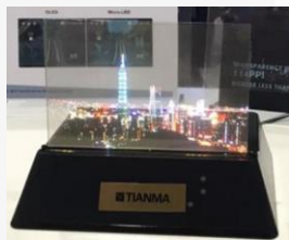
透过率超过60%的7.56英寸 AM Micro LED显示屏 --天马 (2019)
